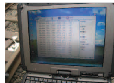
/ Getac 阳光下可视技术最高亮度可达 1200 Nits，图中在 800Nits 的情况下，已经可以清晰阅读屏幕的信息。 /
